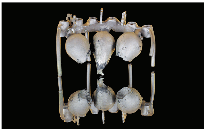
Рис. 28–29. Литая структура только что извлечена из паковой массы
